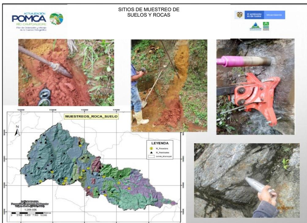
**Figura 12. Toma de muestras de suelo y roca para la evaluación geológica y geotécnica.**
