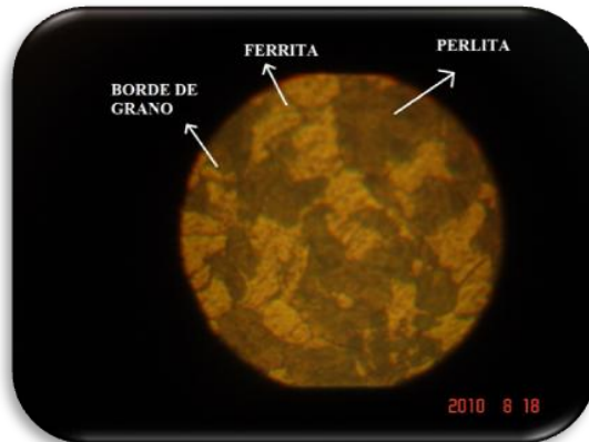
Figura 1 Micro-estructura Acero antes del Temple
