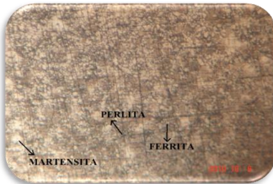
Figura 5 Acero Templado (enfriado en Chorro de Agua)
