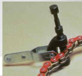
Herramienta para montar y extraer eslabones
