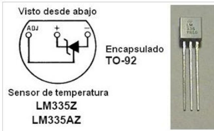
Esquema de conectores del sensor de temperatura **LM335**.
