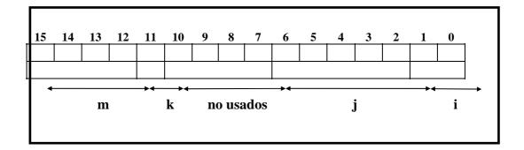
Los campos de bits son útiles para almacenar variables lógicas en un byte, para codificar los bits de un dispositivo, etc. El acceso a los campos de bits se realiza del mismo modo que a los campos de cualquier estructura. Tan sólo hay que tener en cuenta un par de restricciones con los campos de bits: no se permiten matrices y no se puede trabajar con direcciones.
