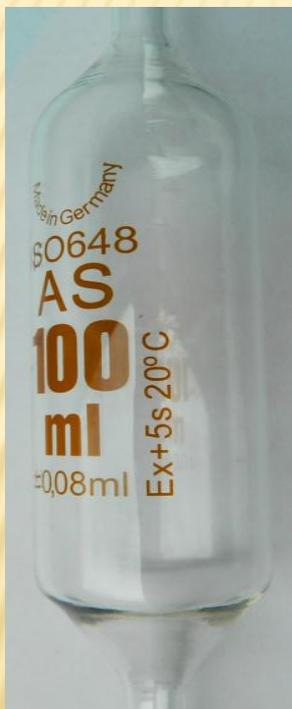
En el material volumétrico con ajuste para verter (Ex) se puede indicar el tiempo de vaciado sobre la superficie del material:
