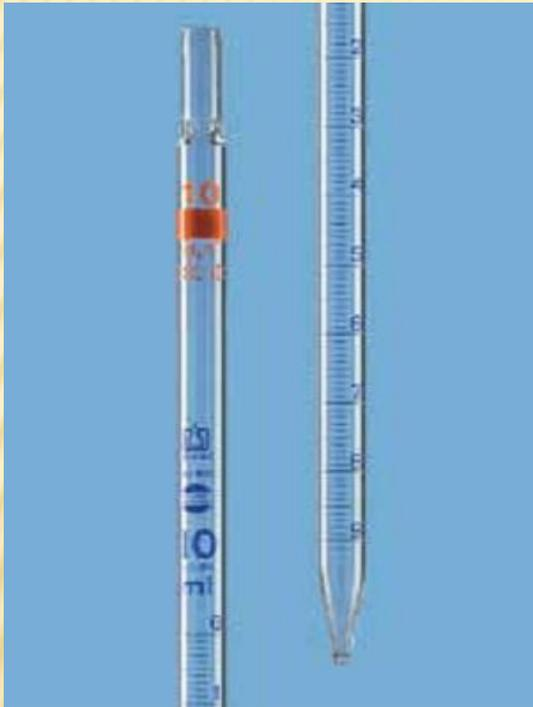
El flujo se empieza a restringir hasta que el extremo inferior del menisco sea tangente a la línea de graduación, y no se permite que transcurra ningún período para que drene líquido adherido a las paredes antes del ajuste final.
