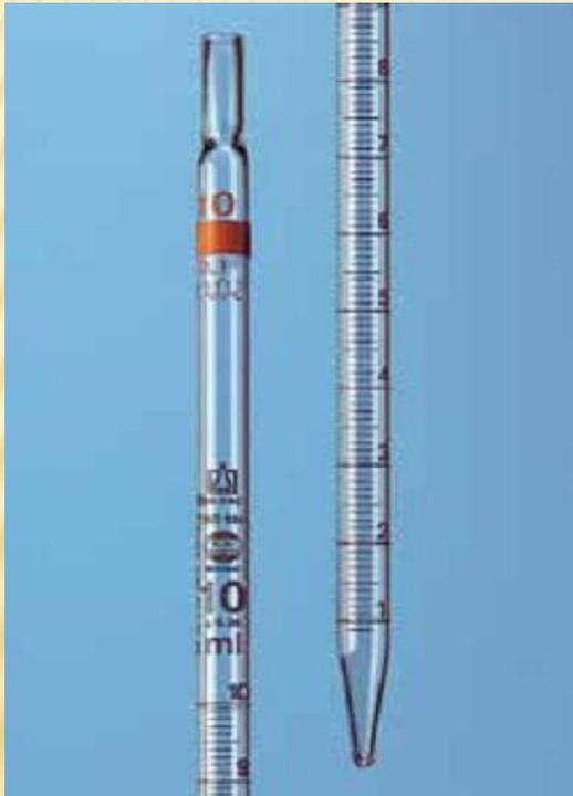
El flujo se restringe hasta que se esté seguro que el menisco permanece quieto en la punta antes de retirar la pipeta del recipiente receptor.
