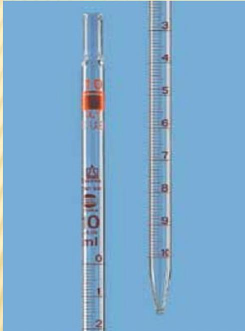
Al vaciar, el flujo se restringe cuando se va a ajustar el menisco sobre la línea de graduación, y no se deja ningún lapso de tiempo para que drene el líquido adherido a las paredes, antes de hacer el ajuste final
