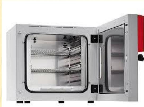
Todo el material volumétrico reutilizable de buena calidad se puede calentar en la estufa de secado o de esterilización hasta  $180\text{ }^{\circ}\text{C}$  sin que haya que temer una variación de volumen. Sin embargo, debe tenerse siempre en cuenta que un calentamiento irregular o un cambio brusco de temperatura provoca tensiones térmicas que pueden conducir a la rotura del vidrio.
