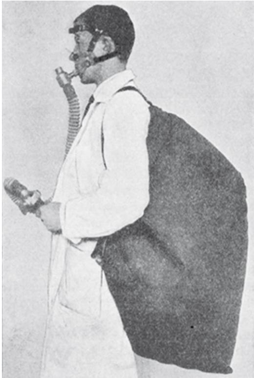
**FIGURA 5-7** Bolsa con tubo lateral, baja en el lado de la mano izquierda, para utilizar mientras se corre. La llave se lleva en la mano izquierda. (Tomado de Hill AV, Lupton H: Muscular exercise, lactic acid, and the supply and utilization of oxygen. Q J Med 16:135-171, 1923.)
