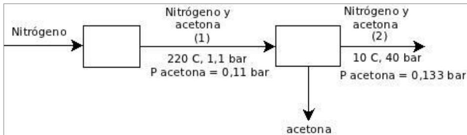
Base de cálculo: 1 m<sup>3</sup> del gas que alimenta el condensador.
