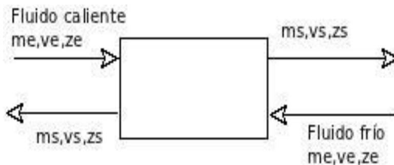
En el anterior diagrama  $m_e$ ,  $v_e$  y  $z_e$  representan la masa, la velocidad y la altura de entrada mientras que  $m_s$ ,  $v_s$  y  $z_s$  se refieren a las mismas cantidades de salida.
